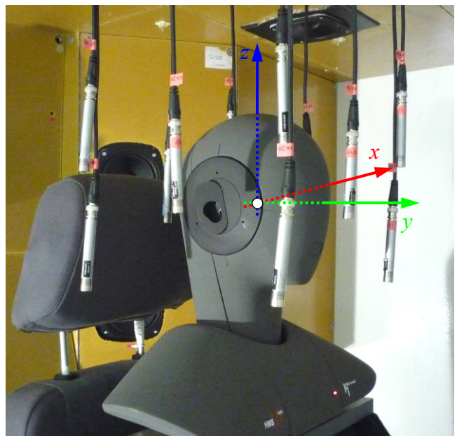
Abb. A.2: Anordnung der Monitormikrofone im Mock-up; Der Koordinatenursprung liegt in der Mitte der Verbindungsachse beider Kunstkopfhörer.
