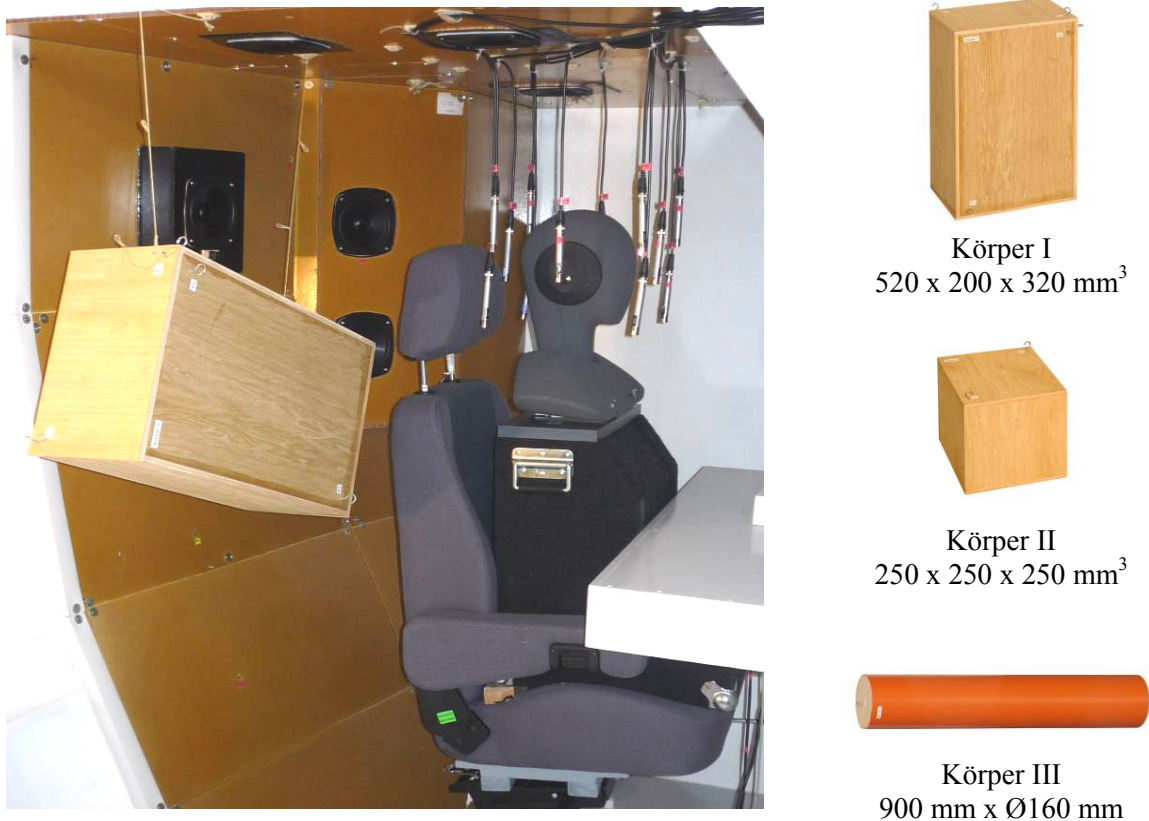
Abb. 5-7: Lademeisterbereich mit Störkörper (links); Abmaße der Störkörper I bis III (rechts).
