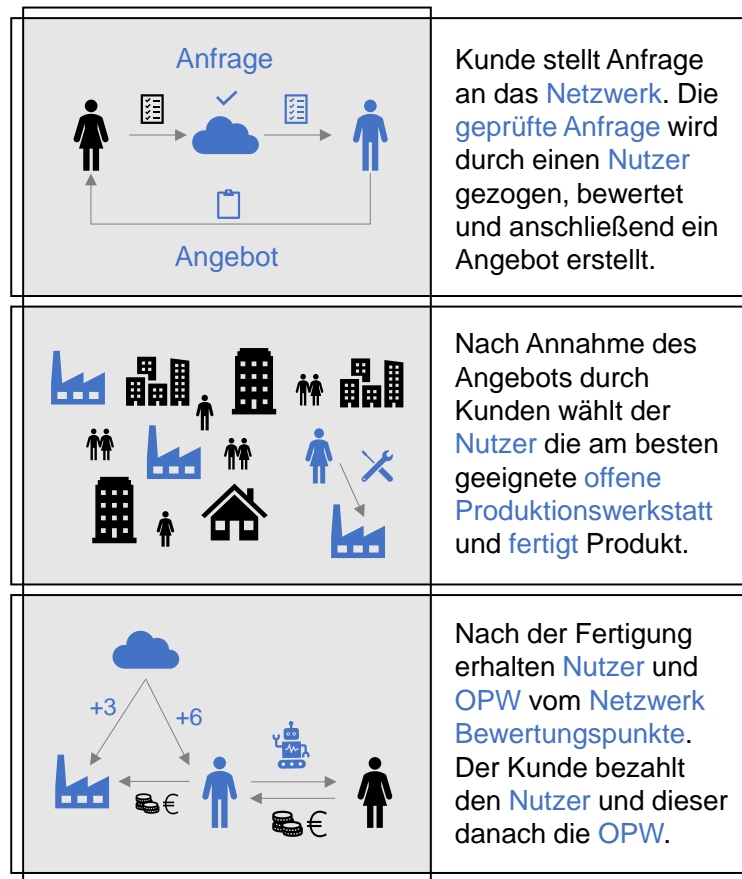
Abbildung 4.24: Ablauf der Fertigung nach Open PPS (Open PPS Anteile in blau)
