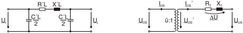
Bild 4.3: (a) \pi -Ersatzschaltung eines Kabels oder einer Freileitung (links) (b) Ersatzschaltung eines Transformators (rechts)
