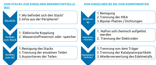
ABBILDUNG 3: SCHEMATISCHER ABLAUF DER ZERLEGUNG EINER POLYELEKTROLYTMEMBRAN- BZ UND EINES STACKS.
