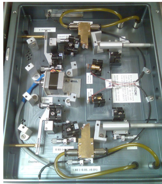
Abbildung 15: GigaJet Twin 20/20 mit zwei symmetrisch aufgebauten Ring-Oszillatoren
