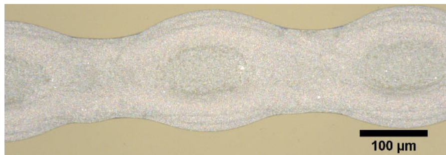
(b) Silberlinie gedruckt mit einem Druckraster von 110 \mu\text{m} , drei Schichten.
