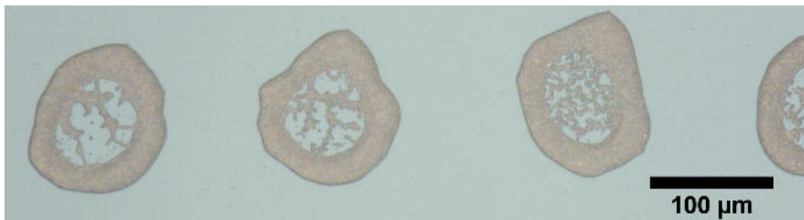
Abbildung 5.10: Silberspots auf thermisch oxidiertem Silizium gedruckt mit einem Druckraster von 200\ \mu\text{m} .
