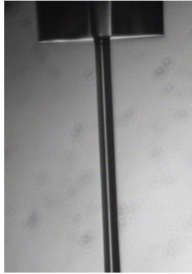
Abbildung 5.4: Austrittsöffnung des Druckkopfes. Im oberen Bereich ist die Glaskapillare zu sehen, aus welcher der Flüssigkeitsstrahl gepresst wird.
