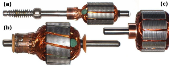
Bild 3.1: Anker der verwendeten Motoren „FPG2“ (a), „DPO“ (b) und „L“ (c), mit Ankerwicklungen und Kommutator.
