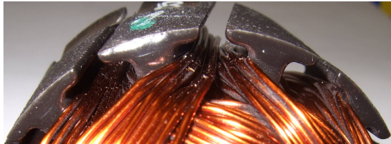
Bild 3.7: Eine maschinelle Bewicklung eines Motorankers kann dafür sorgen, dass die Windungen einer Ankerwicklung nicht mehr konstant übereinanderliegen. Dies verkleinert die Wicklungskapazität.
