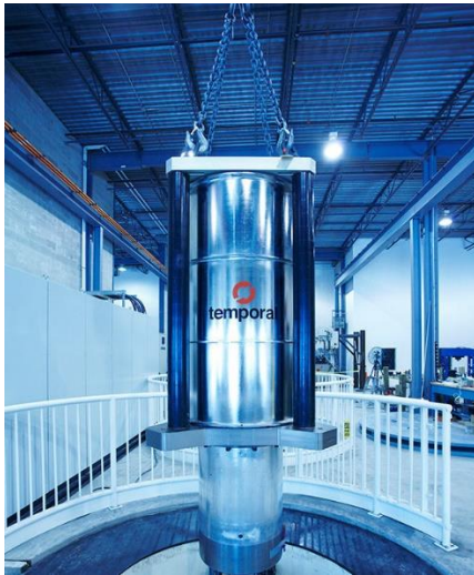
ABBILDUNG 8: EIN 250kW FLYWHEEL, DER FIRMA HHANGUS, ONTARIO/CA. BILD ENTNOMMEN: HTTPS://HHANGUS.COM/PROJECTS/TEMPORAL-POWER-FLYWHEEL-ENERGY-STORAGE/
